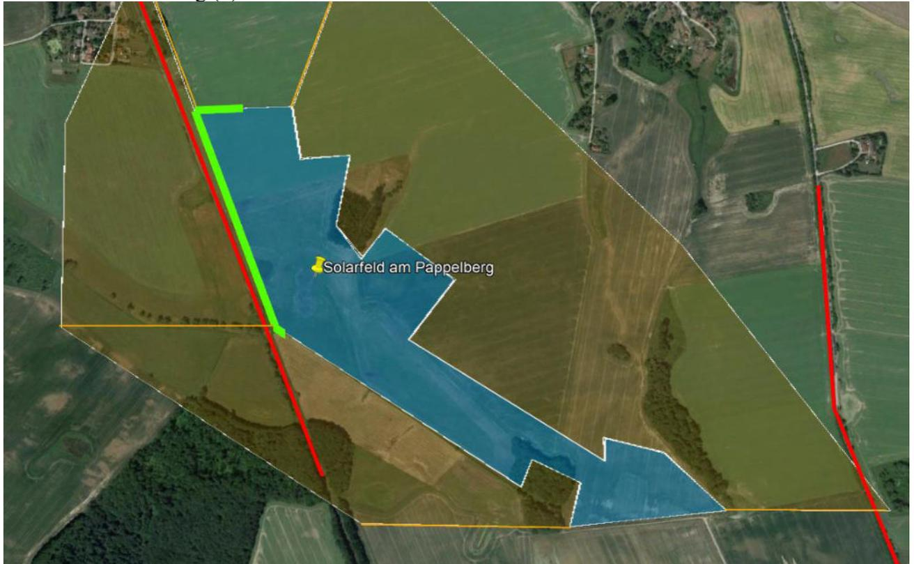
Für den Bahnverkehr liegen die Blendwinkel innerhalb des Blickwinkelbereichs der Bahn. Somit müssten für die Fahrtrichtung Norden nach Süden Blendschutzmaßnahmen erfolgen, siehe den Bereich dafür hellgrün markiert. Die Straße im östlichen Bereich ist nicht betroffen, u.a. weil die Blendung die Straße nur minimal erreicht und weiterhin der vorhandene Bewuchs zwischen Solarpark und Straße eine ausreichende Sichtunterbrechung darstellen würde.
